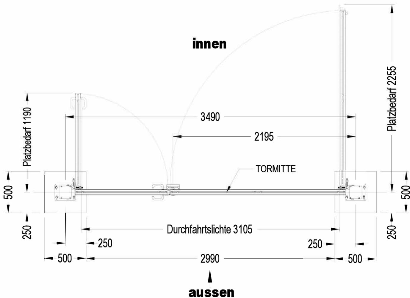
Auf dem Fundamentplan sind konstruktive Mindestgrößen angegeben, die Auslegung und Baugrundbeurteilung obliegt dem Errichter. Bewehrungen (Beispiel: Korb aus Matte R188, Betonüberdeckung 30mm) und Fundamentgröße sind den örtlichen Bodenverhältnissen anzupassen. Betongüte mindestens C25/30 frostsicher. Bitte beachten Sie die vorgeschriebenen Sicherheitsabstände.
