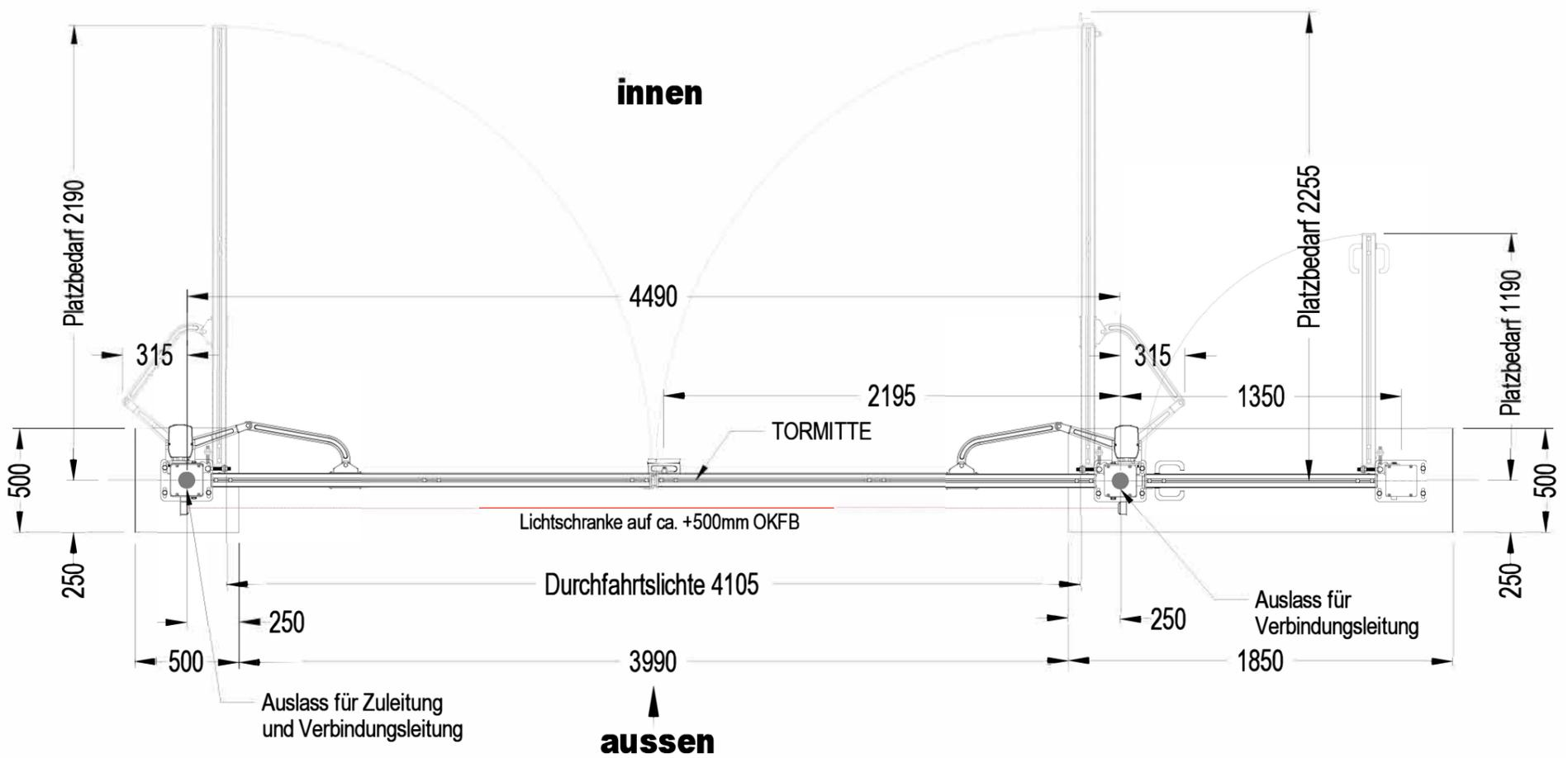
Auf dem Fundamentplan sind konstruktive Mindestgrößen angegeben, die Auslegung und Baugrundbeurteilung obliegt dem Errichter. Bewehrungen (Beispiel: Korb aus Matte R188, Betonüberdeckung 30mm) und Fundamentgröße sind den örtlichen Bodenverhältnissen anzupassen. Betongüte mindestens C25/30 frostsicher. Bitte beachten Sie die vorgeschriebenen Sicherheitsabstände.
