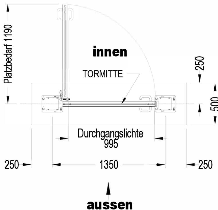
Auf dem Fundamentplan sind konstruktive Mindestgrößen angegeben, die Auslegung und Baugrundbeurteilung obliegt dem Errichter. Bewehrungen (Beispiel: Korb aus Matte R188, Betonüberdeckung 30mm) und Fundamentgröße sind den örtlichen Bodenverhältnissen anzupassen. Betongüte mindestens C25/30 frostsicher. Bitte beachten Sie die vorgeschriebenen Sicherheitsabstände.
